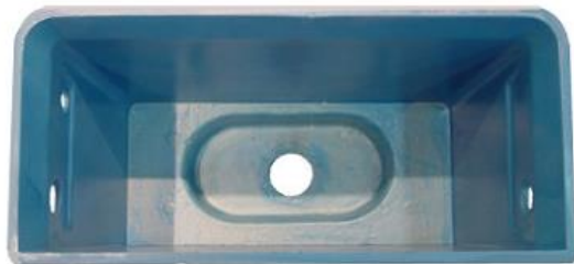
Внутри покрыты тремя слоями герметика
